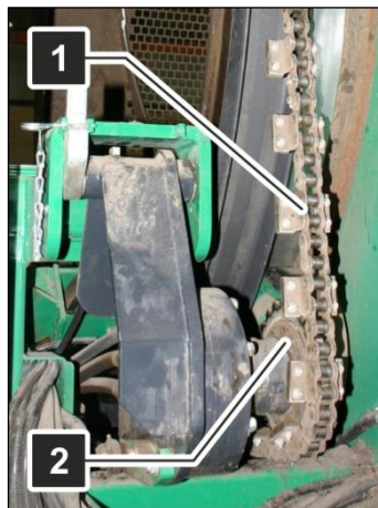
Afb. 114: zeeftrommel SM620 - ketting plaatsen
